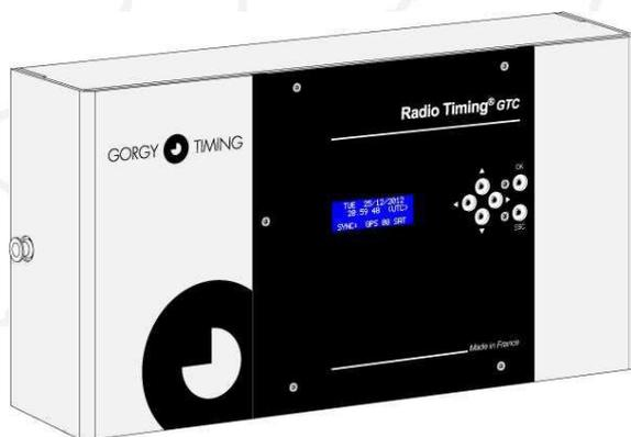
Reloj Patrón programador, con una salida impulsional minuto inverso 1A 24V // ó ½ minuto serie 48V. Cambio automático de la hora de verano/invierno. Puesta en hora automática al conectarlo a la alimentación. Incluye 4 salidas de relé.
